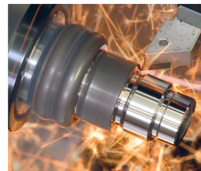
Tournage dur jusqu'à 65 ROCKWELL-HRC
