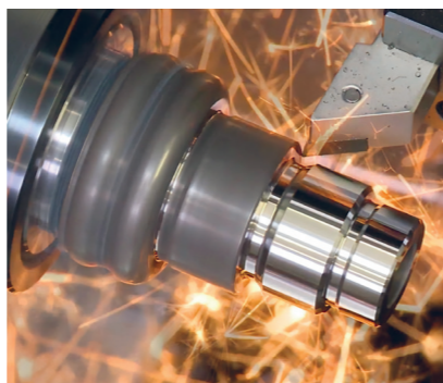
Tournage dur jusqu'à 65 ROCKWELL-HRC Hartdrehen bis 65 ROCKWELL-HRC Hard Turning up to 65 ROCKWELL-HRC
