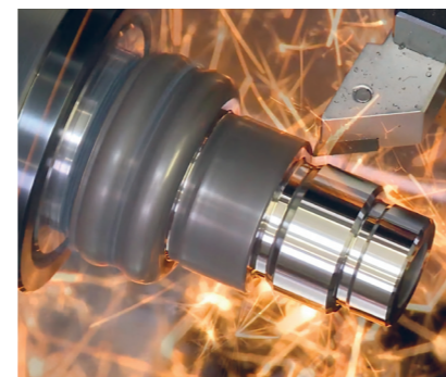
Tournage dur jusqu'à 65 ROCKWELL-HRC
