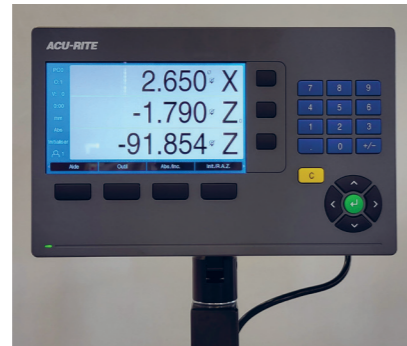
Visualisateur électronique pour les 3 axes Drehmaschinen- Messwertan- zeige für die 3 Achsen Digital readout for the 3 axis
